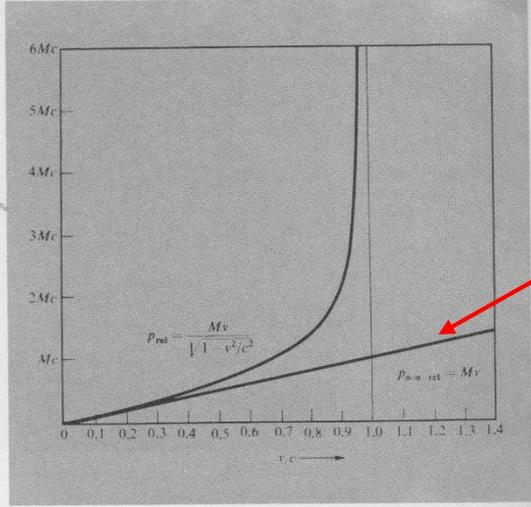
FIGURA 12.6 Affinché la conservazione della quantità di moto sia valida in tutti i sistemi di riferimento, ridefiniamo **p** come segue: per una particella avente velocità **v** e massa a riposo **M** deve essere:
