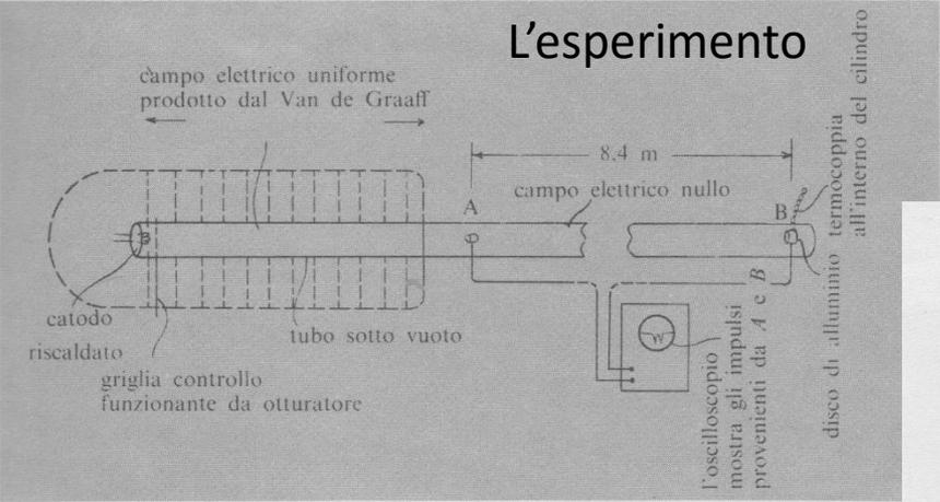
FIGURA 10.43 Schema generale dell'esperimento sulla velocità limite. Gli elettroni sono accelerati nel campo uniforme di sinistra e il tempo di transito fra A e B è misurato con un oscilloscopio.
