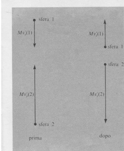
FIGURA 12.5 Nel nuovo riferimento S' la quantità di moto non relativistica nella direzione y' non è la stessa prima e dopo l'urto: vi è un netto aumento della componente y della quantità di moto non relativistica.
